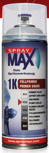
PLUS D'INFORMATIONS Recommandé pour la réparation de petites surfaces / Spot Repair et mise en peinture de pièces, en tant qu' apprêt anti-corrosion ou apprêt garnissant. Supports appropriés : acier, acier galvanisé, aluminium, Plastique renforcé fibres de verre, ancienne peinture durcie, pièces de rechange apprêtées, supports polyester (Ne pas recouvrir avec des produits Polyester et Epoxy)
