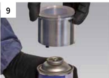
Ouvrir la porte quand le remplissage est terminé. Retirer l'aérosol, le cylindre avec le capuchon.
