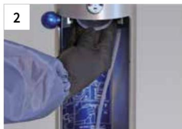
Positionner la disque en plastique sous le piston jusqu'à ce que le clips de sécurité soit en place.
