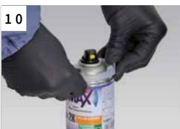
Fixer la bague sur l'aérosol pour maintenir le capuchon en place.
