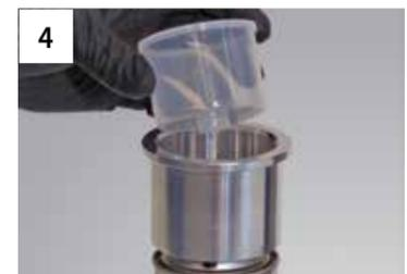
Placer le cylindre sur le dessus, insérer le capuchon Fillclean et pousser vers le bas.
