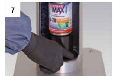
Pour l'aérosol de 250 ml, un adaptateur (no d'article 990014) est requis adapter la hauteur avant le remplissage.
