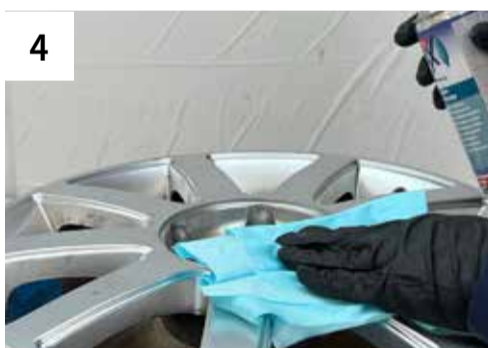
4 Sorgfältig reinigen mit Silikonentferner und Staubbindetuch
