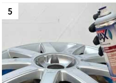
5 2K Epoxy Grundierfüller applizieren, 2-3 Schichten
