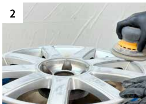
2 Maschinell schleifen mit P320
