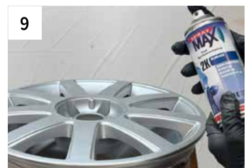
9 Nach Abluftzeit 2 Spritzgänge 2K Klarlack applizieren
