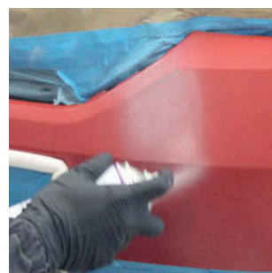
Secouer l'apprêt UV, appliquer environ 1 à 2 couches (40-50 µm), puis observer un temps de désolvatation pendant environ 1 minute.
