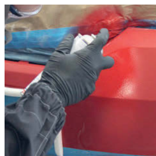
Appliquer la teinte de base en 2-3 couches. Séchage à l'air.
