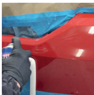
Nettoyer la zone endommagée avec un nettoyant silicone. Ensuite, polir la surface nettoyée puis la nettoyer à nouveau.
