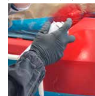
Bien nettoyer la surface après le sablage avec le SprayMax Wax & Grease Remover 3680094, passer un chiffon gomme, puis appliquer la couleur de base jusqu'à opacité.
