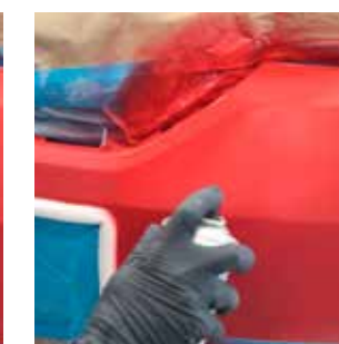
Une fois la couleur sèche, essuyer la surface avec le chiffon gomme. Appliquer 1-2 couches du transparent UV SprayMax 5680059 en laissant évaporer 1 min entre les couches.
