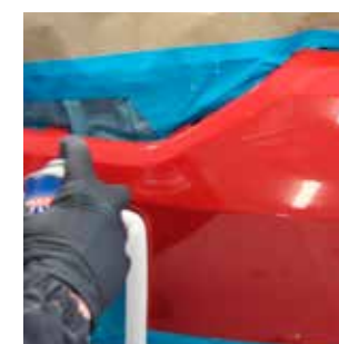
Laver à l'eau savonneuse, puis nettoyer généreusement la surface avec le SprayMax Wax & Grease Remover 3680094.
