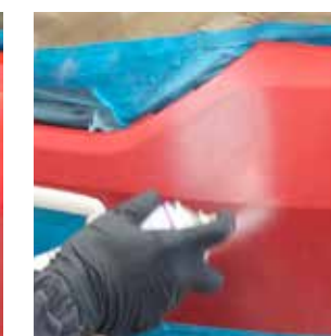
Bien agiter l'apprêt UV SprayMax 5680019 pendant 2 minutes, puis appliquer 1-2 couches. Laisser 1 minute d'évaporation entre les couches.
