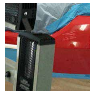
Domage: égratignure sur un pare-chocs. L'utilisation d'une lampe à infrarouge entre les couches facilitera l'évaporation (en particulier dans des conditions de forte humidité).
