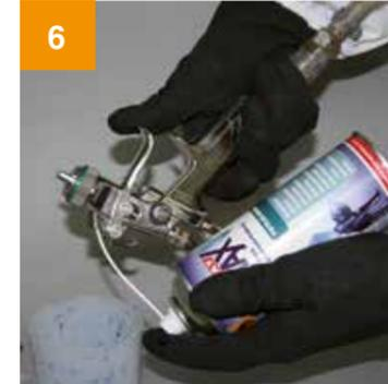
6 Pistole herumdrehen und Farbverschmutzungen ausspritzen (Luftzufuhr minimal eingestellt lassen).
