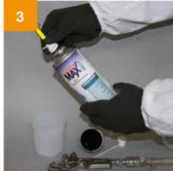
3 Standardsprühkopf mit einer leichten Drehbewegung abnehmen.
