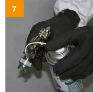
7 Restfarbe von oben ausspritzen (Luftzufuhr minimal eingestellt lassen).
