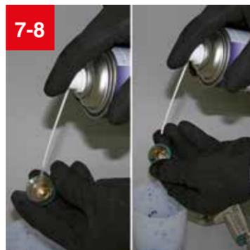
7-8 Luftdüse abschrauben und Farbdüse außen reinigen. Düsenkopf innen reinigen. Düsenkopf aussen reinigen.
