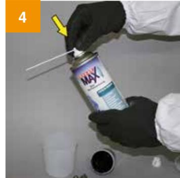
4 Lanzettensprühkopf mit einer leichten Drehbewegung aufsetzen.
