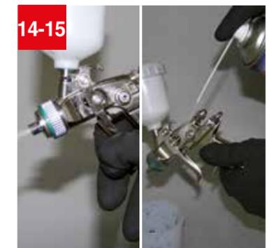
14-15 Reiniger in Farbbecher sprühen und Pistole durchspritzen. Lackierpistole aussen reinigen.
