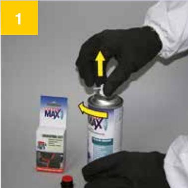
1 Standardsprühkopf mit einer leichten Drehbewegung abnehmen.
