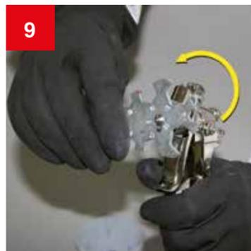
9 Farbdüse abschrauben. Farbnadel entfernen und reinigen.
