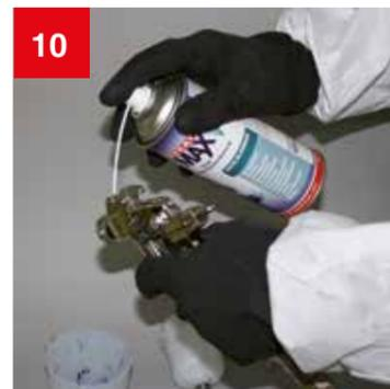
10 Restfarbe von oben ausspritzen (Luftzufuhr minimal eingestellt lassen).
