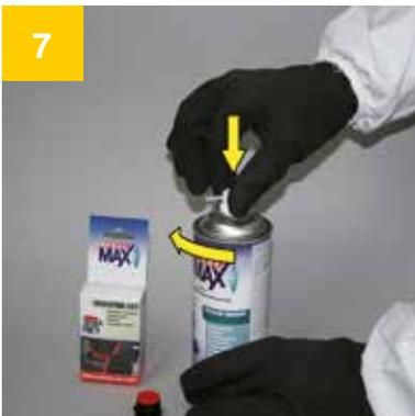
7 Standardsprühkopf mit leichter Drehbewegung aufsetzen.
