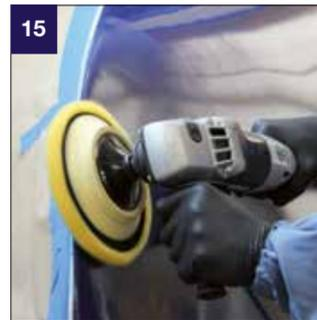
Staubeinschlüsse und Übergangszonen ggf. aufpolieren (möglich nach 24 h)
