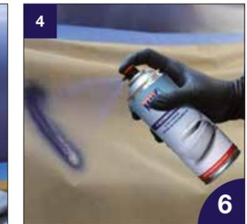
Zuerst Farbton prüfen durch Probesprühen
