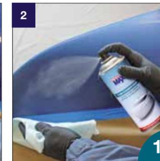
Reinigen mit Aqua Silikon-Entferner
