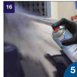
Politur mit 1K Finish Kontrollspray überprüfen. Gleichmäßig aufsprühen
