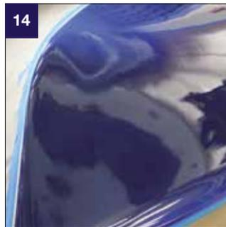
2K Decklack trocknen lassen: staubtrocken nach 1,5h und polierbar nach 24 h bei 20°C
