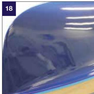
Lackierprozess bis Decklackbereich (über Wasserlinie) abgeschlossen
